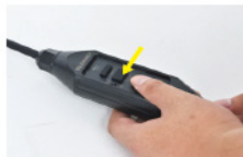
2. Drücken Sie die Reset-Taste, die Anzeige leuchtet auf.
