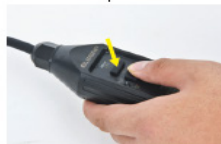
3. Drücken Sie die Test-Taste, die Anzeige erlischt.
