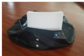
3) Voeg het schuimdeel met de drie gaten toe en zorg ervoor dat de gaten uitgelijnd zijn met de gaten van het buitenzeil.
